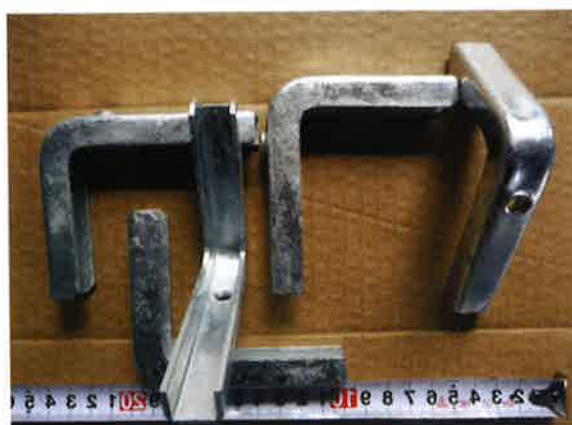
プレート加工品(ドブ) タップ加工あり * コーナー部の加工重要 *
