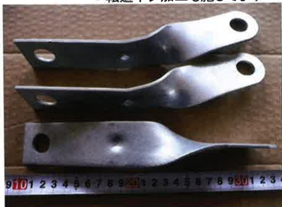
プレート加工品(ドブ) "高さ交差全数検査実施品" * 架線金物 *
