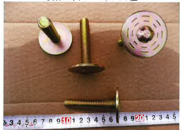
丸棒・プレート溶接加工品(クロメート) 製作ロット=5,000個
